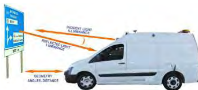
Abb. 14 – Beispiel eines dynamischen Schildermesssystems
